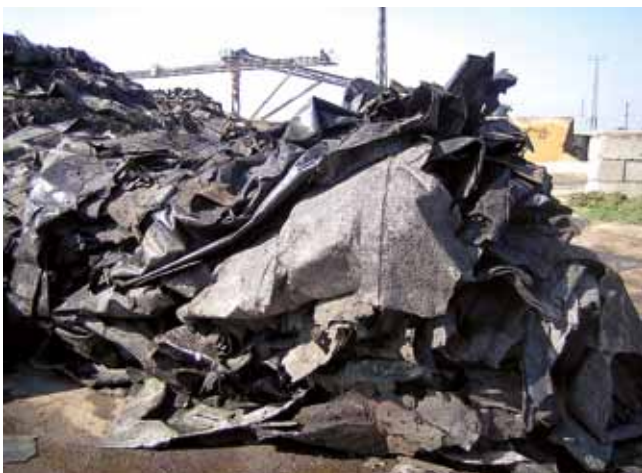
Bild 1: Bitumendachbahnen fallen zu Tausenden Tonnen bei Rückbauten insbesondere von Flachdächern an
